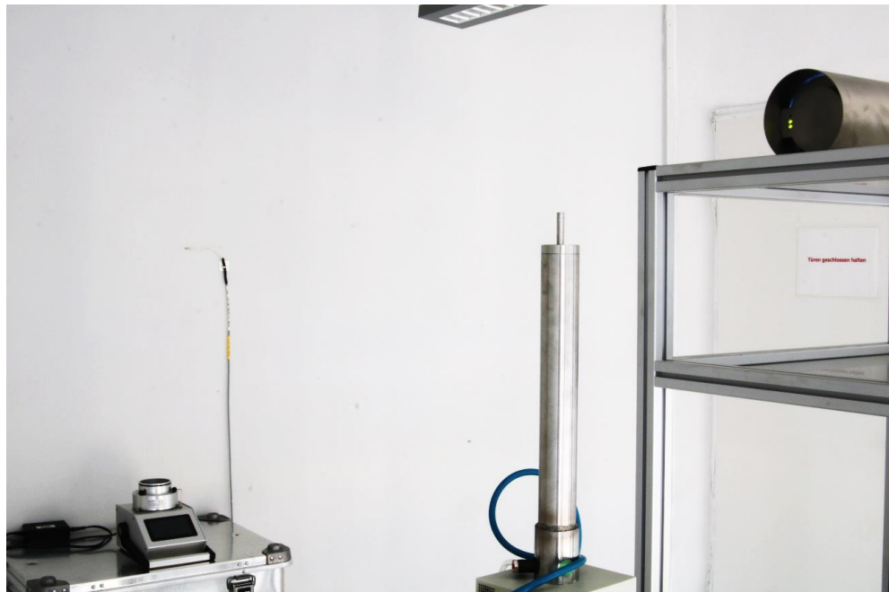
Bild 1: Aufbau des FreshAir-Luftreinigungsgerätes im Testbüro mit Dosiergerät und Luftkeimsammler.
